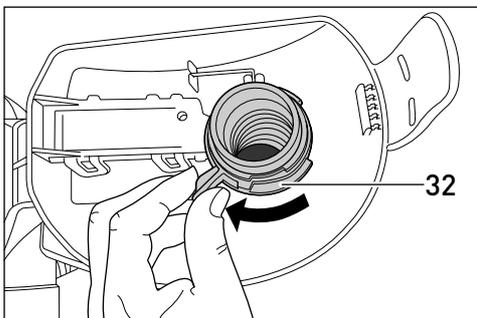
Nur wenn der Abluftfilter richtig montiert ist, d.h. die Kunststoffschienen richtig in der Nut liegen und die Filterbefestigungsringe den Filter abdichten und verschlossen sind, kann der Abluftfilter seine Wirkung entfalten.
