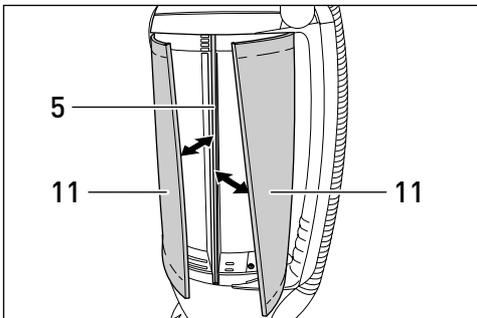
muss gewechselt werden, wenn er stark verschmutzt ist oder spätestens nach 20 Filtertüten. Gleichzeitig sollte auch der außen liegende Abluftfilter (11) gewechselt werden. Hierzu müssen die beiden Filterbefestigungsringe (12) vorsichtig gelöst und seitlich entfernt werden. Dann die beiden Kunststoffschienen aus der Nut im Filtergehäuse (5) herausziehen und den Abluftfilter entfernen. Die Montage erfolgt in umgekehrter Reihenfolge.
