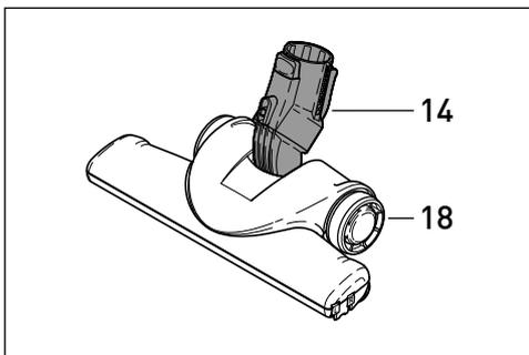
bürste in alle Richtungen beweglich und umsteuert spielerisch jedes Hindernis. Die Elektroteppichbürste ist in der Stärke der Bürstenwirkung variabel und sorgt für eine optimale Reinigung bis zum Rand.
